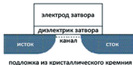
Рис. 2. Принципиальная схема элементарного полупроводникового транзистора, составляющего основу больших интегральных схем (несколько миллионов элементарных транзисторов на кристалле)
