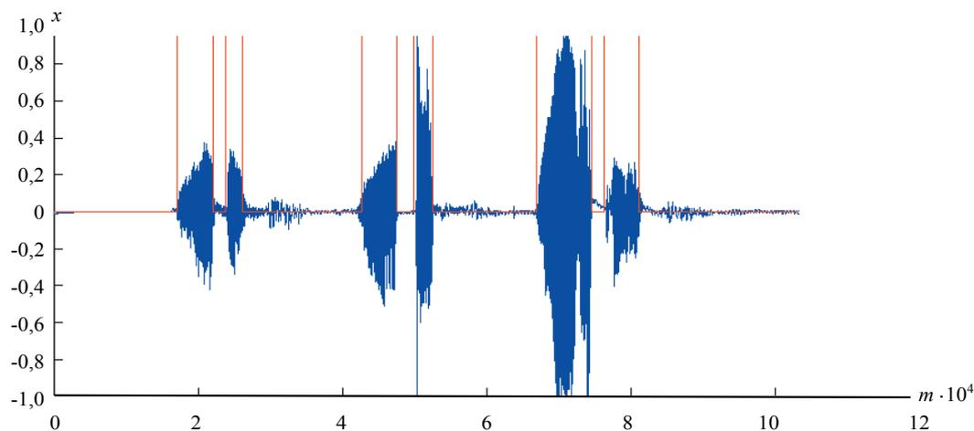
Рис. 4. График определения VAD в речевом сигнале
