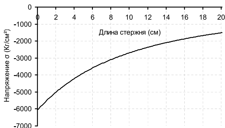
Рис. 4. Поле распределения напряжений по длине стержня переменного сечения
